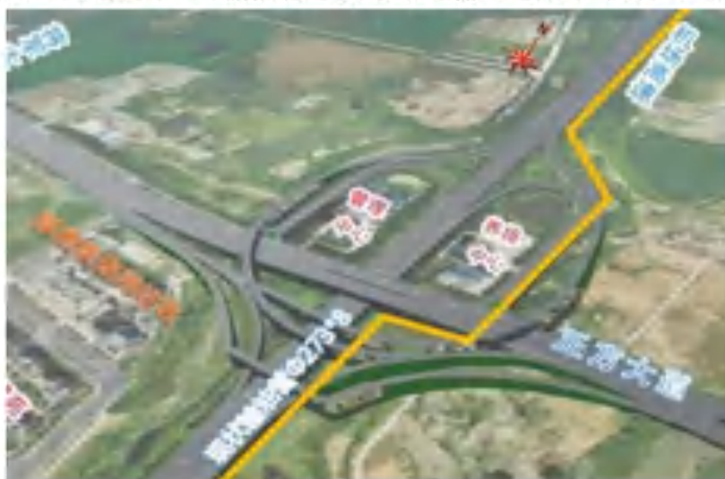
图 1.1-4 现状输油管道与秣陵互通改造后位置图
