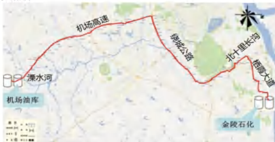
图 1.1-1 现状输油管道路由图
